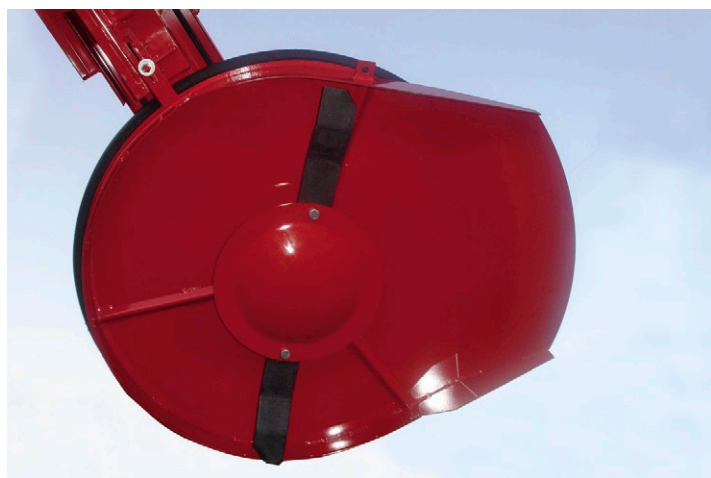
Gleitteller unter der Schwenkscheibe verhindert eine Verletzung der Graßnarbe
