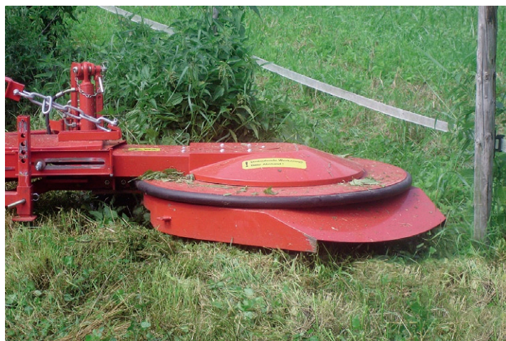
Sehr flache Schwenkscheibe zum Unterfahren der Zäune
