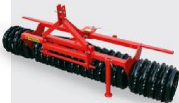
CW-F 51/3024 Front-/Heckanbauvariante. Durch einfaches Umstecken eines Bolzens wird von Front auf Heck umgerüstet.
